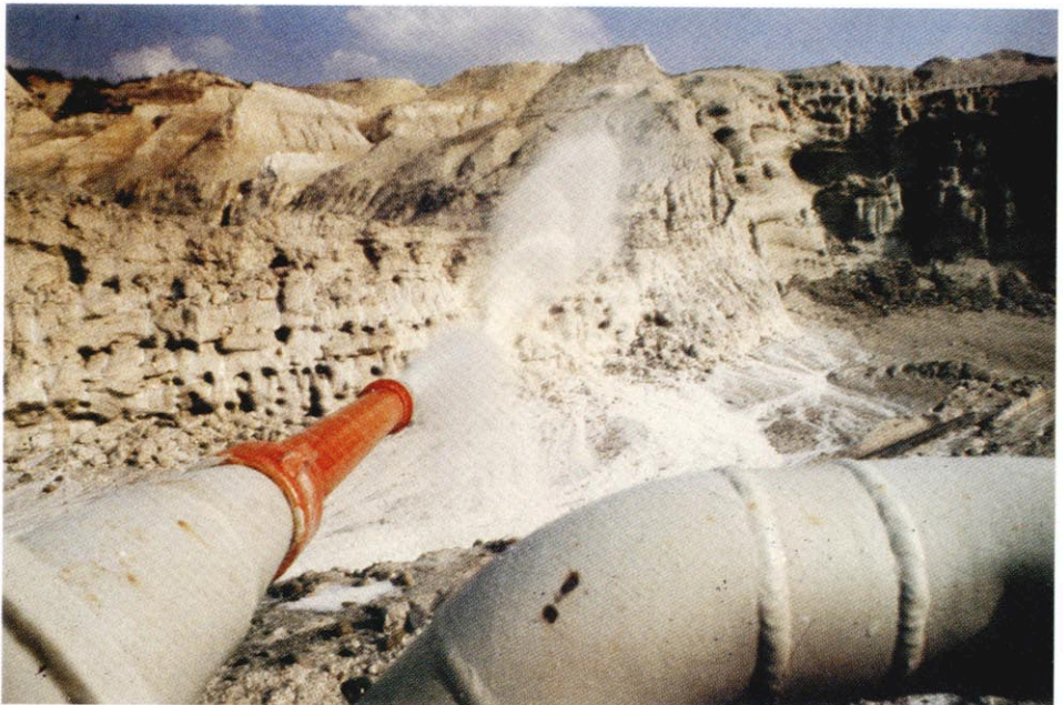
Foto 2. Gewinnung von Kaolin im Tagebau der Firma E. Kick, Schnaittenbach/Opf., durch Ausspülen der Kaolinsubstanz aus dem Kulmbacher Konglomerat mittels eines hydromechanischen Verfahrens (Monitoring) bei 14 atü Druck und einem Wasserverbrauch von ca. 120 cbm/h. – Aufnahme: Werkfoto der Firma E. Kick 1983.
